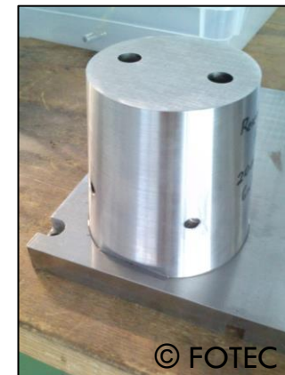
Hybrid Bauteil (Kombination aus additiver und subtraktiver Fertigung)
