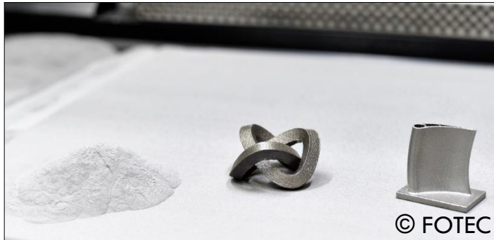
Metallpartikel werden zu soliden Bauteilen verbunden (Schweißprozess)
