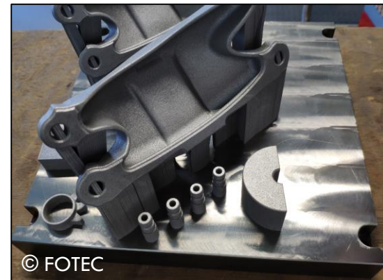
Stützstrukturen für Position, Wärmetransport und Vermeidung von Verzug
