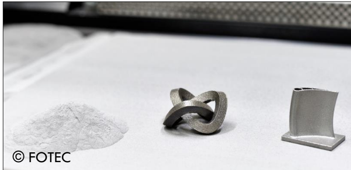
Metallpartikel werden zu soliden Bauteilen verbunden (Schweißprozess)
